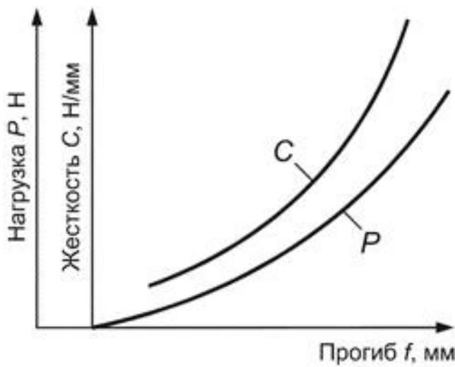
Жесткость пружины  $C$ , Н/мм, определяют, как минимум, в пяти точках зависимости нагрузки  $P$  от прогиба  $f$  как производную  $dP/df$ .
