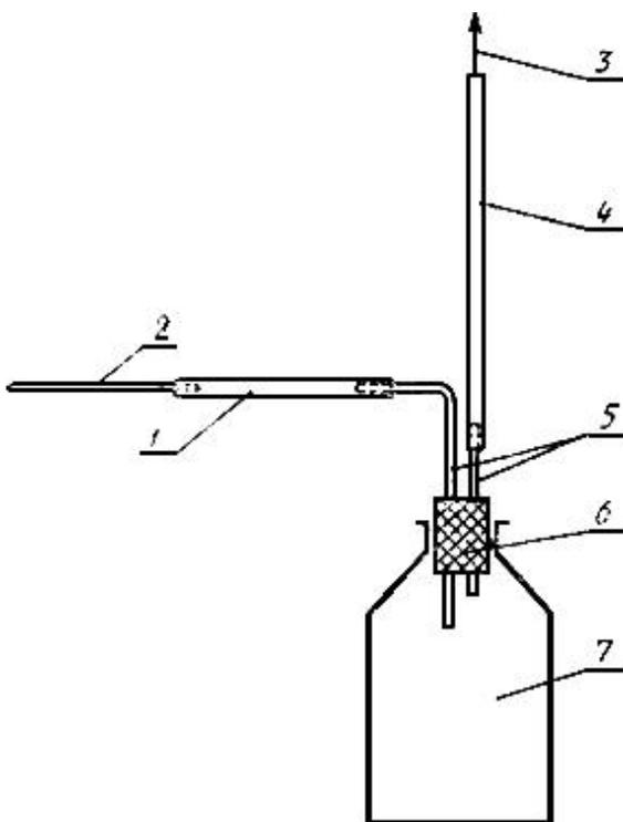
1 - трубка ПЭНД  $d_y$  - 6 мм,  $l \approx 600-700$  мм; 2 - острый наконечник для отбора пробы из мешка (титан
