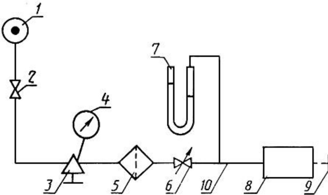
1 - соединение с источником сжатого воздуха; 2, 6 - краны; 3 - редуктор; 4 - манометр; 5 - технологический фильтр; 7 - жидкостный манометр; 8 - испытуемый фильтрующий элемент; 9 - заглушка; 10 - соединительные трубы и шланги
