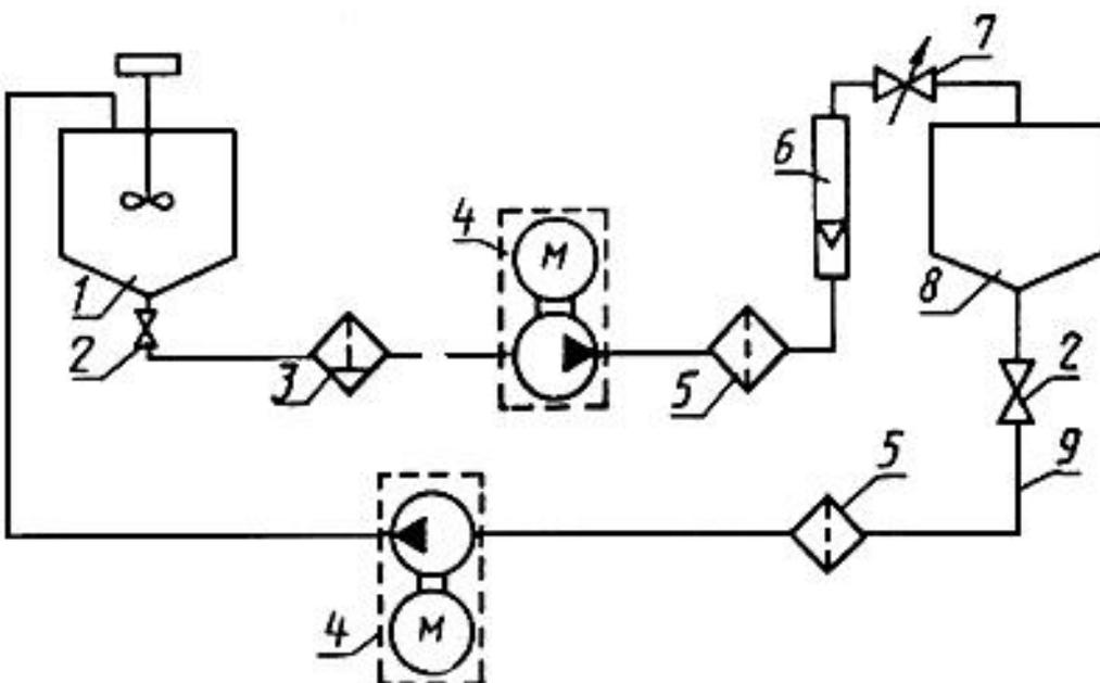
1 - расходный бак; 2, 6 - краны; 3 - испытываемый фильтр; 4 - насос; 5 - технологический фильтр; 6 - ротаметр; 8 - вспомогательный бак; 9 - соединительные трубы и шланги
