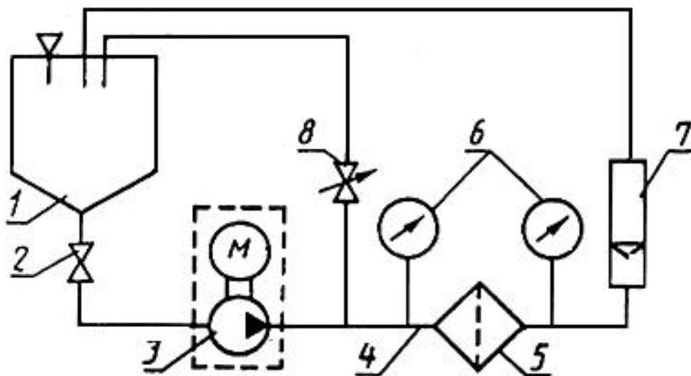
1 - расходный бак; 2, 8 - краны; 3 - насос; 4 - соединительные трубы и шланги; 5 - испытуемый фильтр; 6 - манометры; 7 - расходомер
