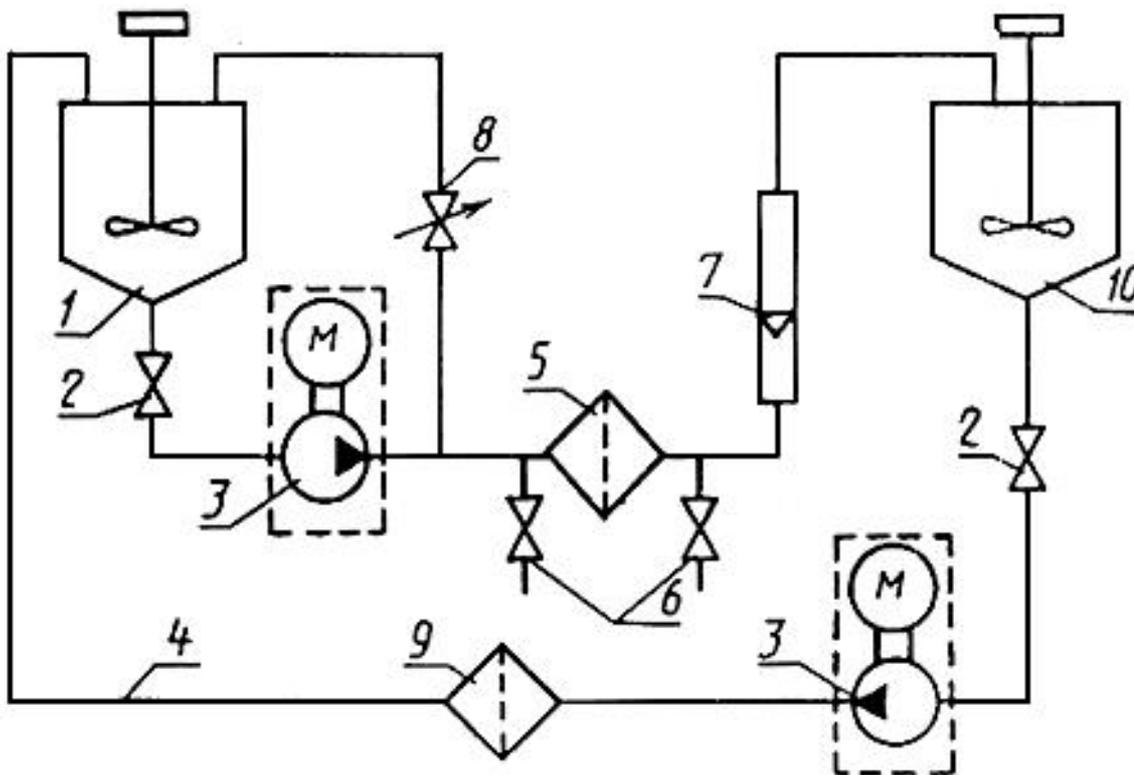
1 - расходный бак; 2, 8 - краны; 3 - насос; 4 - соединительные трубы и шланги; 5 - испытуемый фильтр; 6 - краны отбора проб; 7 - расходомер; 9 - технологический фильтр; 10 - вспомогательный бак
