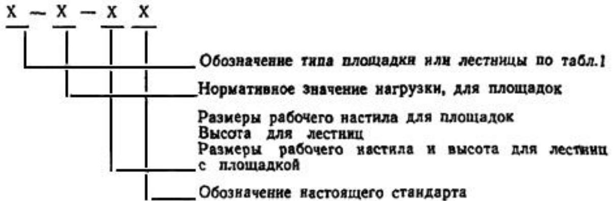
Пример условного обозначения площадок, навешиваемых на лестницы, из алюминиевых сплавов с нормативным значением нагрузки 1000 Н и размерами рабочего настила 0,6x0,6 м:
