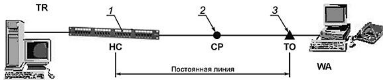
Рисунок 15. - Модель постоянной линии горизонтальной кабельной подсистемы с тремя точками коммутации
