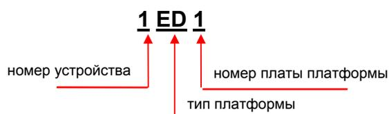
Рисунок 4.10 – Пример обозначения платформы дискретной
